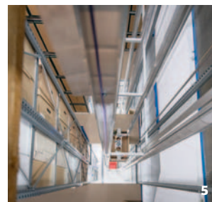
1 Robotické vozíky se pohybují po hliníkovém gridu. Co chvíli spouštějí nakládací čelisti do hlubiny šachty a vyzvedávají z ní přepravku. 2 Marek Ječmének (vpravo) a Petr Helcl v testovacím provozu kácovského skladu. 3 4 5 Roboti si mohou v mimoúrovňových skladech předávat boxy mezi podlažími. Na spodním snímku vpravo je propojovací šachta.
